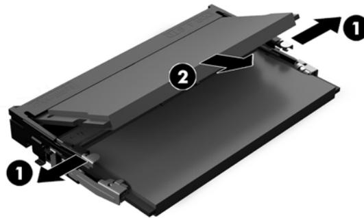
4. Deslice el nuevo módulo de memoria en la ranura en un ángulo de aproximadamente 30 grados (1) y luego presione el módulo de memoria hacia abajo (2) para que los pestillos de bloqueo encajen en su sitio.
