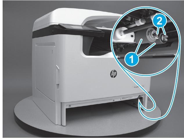
**HR** **Uklanjanje valjka podizača i valjka ulagača:** Pogledajte u udubljenje za ladicu i pronađite valjak podizač i valjak ulagač (oznaka 1). Stisnite jezičac za zaključavanje na valjku (oznaka 2), a zatim gurnite valjak s osovine.
