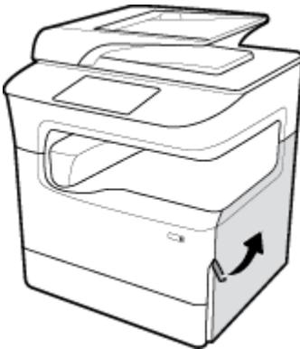
2. Tire de la restricción izquierda hacia el centro de la impresora y elimínela de la impresora.
