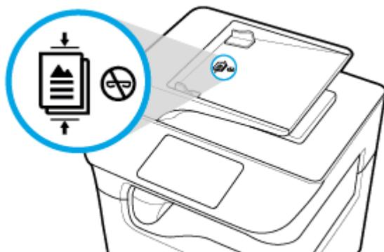
4. Empuje los documentos a la izquierda hasta que queden detenidos por el mecanismo del alimentador en la cubierta del alimentador de documentos. Aparece un mensaje de **Documento cargado** en el panel de control de la impresora.
