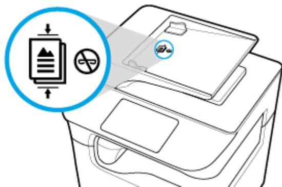
4. ドキュメント フィーダーのカバーの下のフィーダー メカニズムによって停止するまで、ドキュメントを左に押し込みます。プリンターのコントロールパネルに、**ドキュメントをセット**というメッセージが表示されます。
