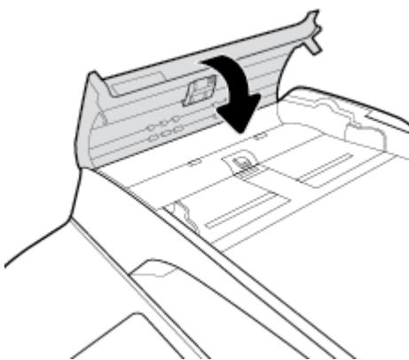
4. 打开扫描仪盖板。如果纸张卡在白色塑料底板后面，请轻轻拉出纸张。
