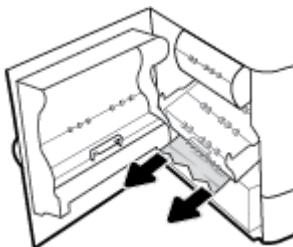
5. 将双面打印器插入打印机，直至卡合到位。
