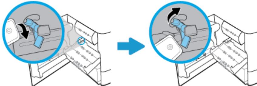
5. 将双面打印器插入打印机，直至卡合到位。
