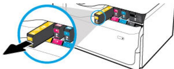
4. 请不要触碰墨盒上的金属触点。触点上有指印会导致连接错误。
