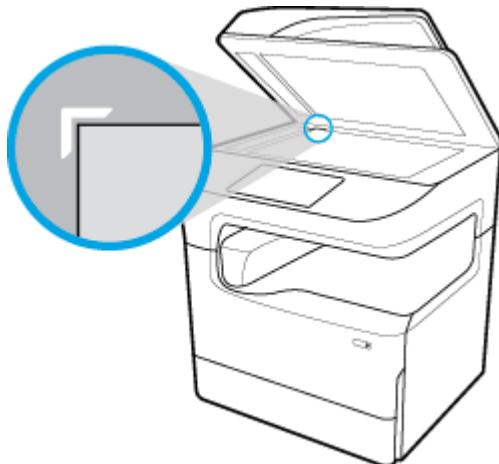
**3.** 将原件正面朝下放在扫描仪玻璃板上。 使用扫描仪玻璃板顶部的介质标志来确定文档方向。
