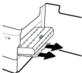
7. 将双面打印器插入打印机，直至卡合到位。
