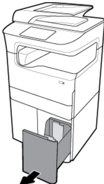
2. 完全打开纸张长度导轨。
