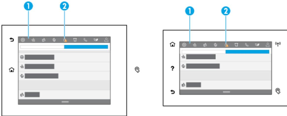
1 大图标出现在仪表板的顶部。这些图标指示产品的状态并使您能够更改产品设置。
