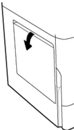
2. 根据纸盒上的介质标志，将信封放入纸盒 1，其中正面朝下，信封顶部朝向打印机背面。
