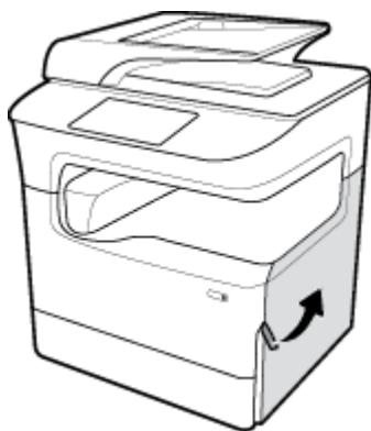
2. 朝打印机中间位置拉动左侧限制器，然后将其从打印机上取下。
