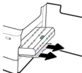
5. 将双面打印器插入打印机，直至卡合到位。
