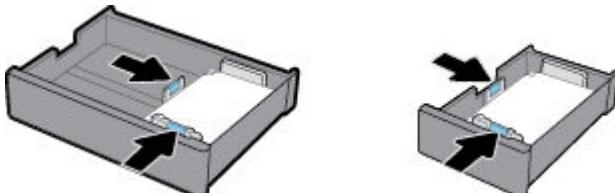
4. 向下按纸张，确保纸叠高度低于纸盒后侧的纸叠高度指示器。
