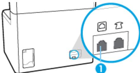
本产品为模拟设备。HP 建议在专用模拟电话线路上使用本产品。如果您使用数字环境（例如 DSL、PBX、ISDN 或 VoIP），请确保使用正确的过滤器并正确配置数字设置。有关更多信息，请联系您的数字服务提供商。
