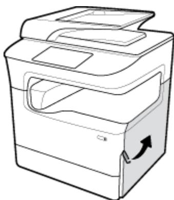
2. 將左側止擋朝印表機中央拉動，然後從印表機中取出。
