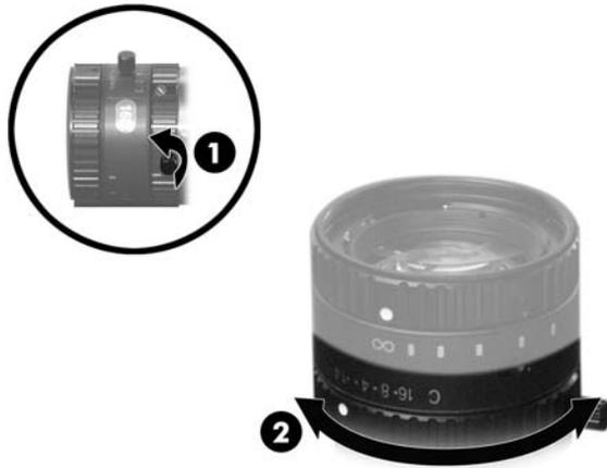
Para configurar el foco de la cámara, afloje el tornillo del lente que está más distante del cuerpo de la cámara **(1)** y gire el anillo de ajuste para alejarlo de la cámara **(2)**. Apriete el tornillo cuando la apertura esté establecida.
