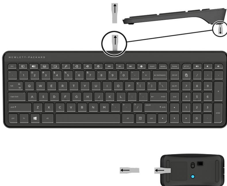
2. マウスの電源ボタン (1) を右方向にスライドさせて、マウスの電源を入れます。
