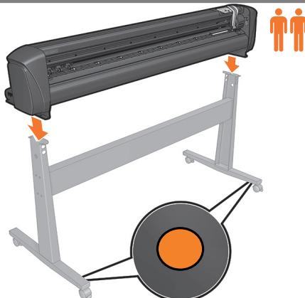
**RU** Установите корпус резака на основание так, чтобы полая часть поперечины основания располагалась сзади, а наклейки спереди.
