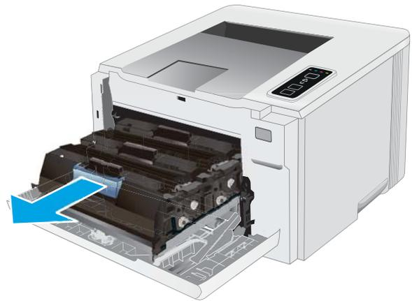
3. Fassen Sie die Tonerpatrone am Griff, und heben Sie sie gerade nach oben heraus.
