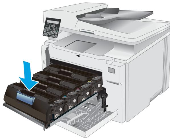
8. Закройте отсек картриджа с тонером.
