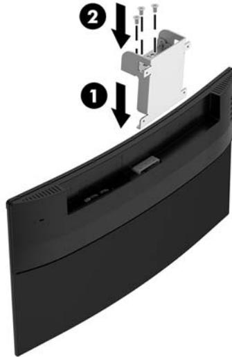
3. Asegure la placa de montaje a la pared o a un brazo oscilante de su elección mediante los cuatro tornillos incluidos con el soporte de montaje VESA.
