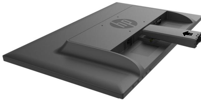
3. Bringen Sie die Basis an der Unterseite des Ständerarms an, bis die mittleren Löcher ausgerichtet sind und automatisch einrasten.
