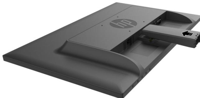
3. Fixez la base dans le fond du bras du support jusqu'à ce que les trous centraux soient alignés et verrouillés automatiquement.
