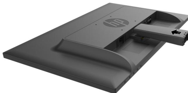
3. Fixez la base dans le bas du bras du socle jusqu'à ce que les trous centraux soient alignés et verrouillés automatiquement .
