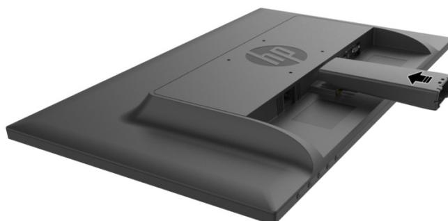
3. 中央の穴が整列して自動的にロックされるように、スタンドアームの底部にベースを取り付けます。
