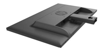
3. Acople la base en la parte inferior del brazo del pedestal hasta que los orificios centrales estén alineados y quede bloqueada automáticamente.
