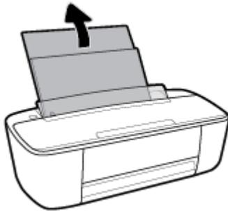
2. Insérez une pile de papier dans le bac d'alimentation dans le sens de la longueur et face à imprimer vers le haut. Faites-la glisser jusqu'à ce qu'elle soit calée.
