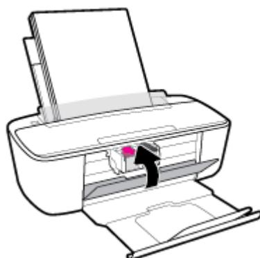
8. Rebranchez le cordon d'alimentation et tout autre câble à l'arrière de l'imprimante, puis appuyez sur le bouton **Mise sous tension** (⏻) pour mettre l'imprimante sous tension.
