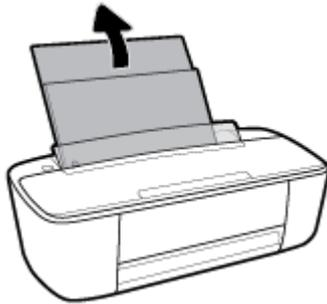
2. Insérez une pile de papier photo à l'extrême droite du bac d'entrée dans le sens de la longueur et face à imprimer vers le haut. Faites-la glisser jusqu'à ce qu'elle soit calée.
