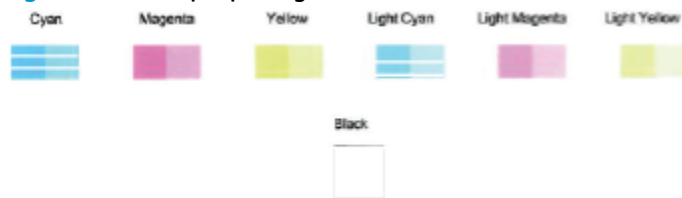
Figur 9-2 Eksempel på fargeblokker med defekter
