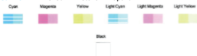
Slika 9-2 Primer barvnih blokov z napakami
