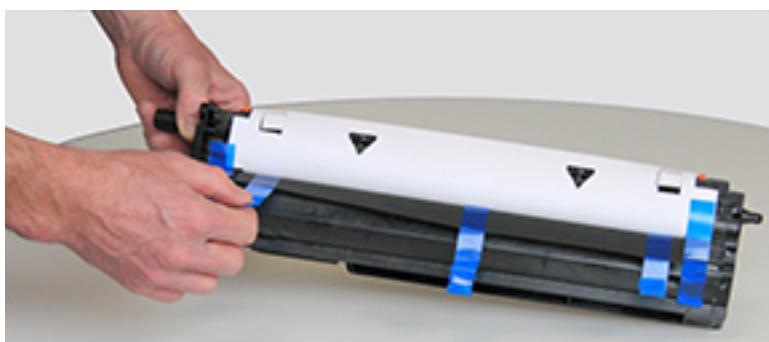
3. Uklonite narančaste transportne zatvarače iz jedinice za obradu slike.
