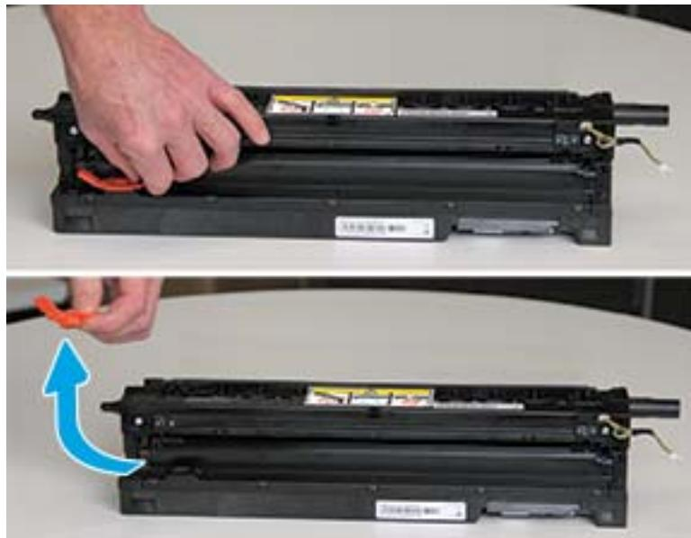
**OPREZ:** Nakon što uklonite čep, jedinica za obradu slike mora ostati u ravnini. Sadržaj se može izliti ako se jedinica za obradu slike nagne.
