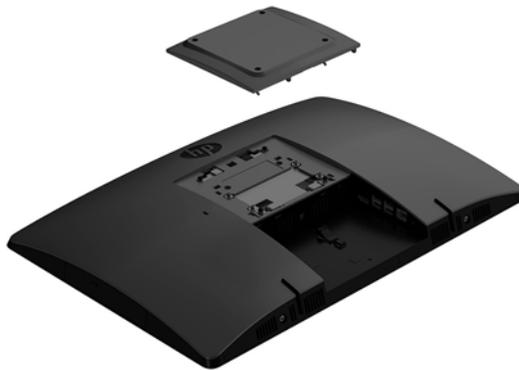
2. Per collegare il computer ad un braccio snodabile (venduto separatamente), inserire le quattro viti da 20 mm fornite in dotazione con il computer attraverso i fori sulla piastra del braccio snodabile e nei fori di montaggio sul computer.
