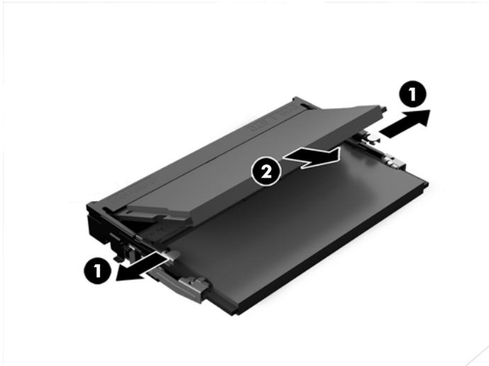
5. Deslize o novo módulo de memória para dentro da ranhura com um ângulo de aproximadamente 30° (1) e, em seguida, pressione o módulo de memória para baixo (2) de modo a encaixar firmemente na posição.
