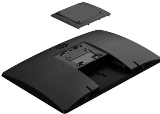
2. Para instalar o computador num braço oscilante (adquirido separadamente), introduza os quatro parafusos de 20 mm incluídos com o computador nos orifícios da placa do braço oscilante e nos orifícios de montagem do computador.
