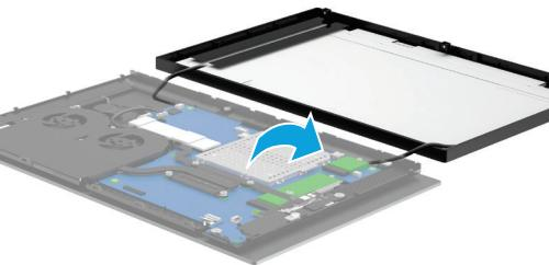
將顯示器面板旋轉到電腦主體裝置上方，並放在平坦的表面上，以乾淨的軟布墊在下面。
