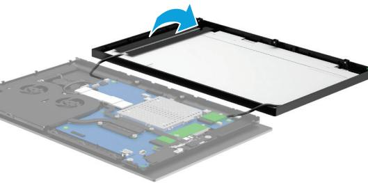
Otočte panel displeje nad horní stranou jednotky hlavy počítače a položte jej na rovný povrch pokrytý měkkým čistým hadříkem.
