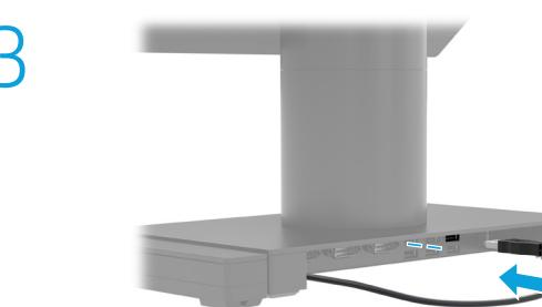
Priklopite kabel USB bralníka prstních odtisov do portu USB vrste A na vhodno/izhodni postaji.
