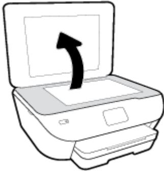
2. Limpe o vidro e a parte posterior da tampa do scanner utilizando um pano macio e sem fiapos levemente umedecido com um produto neutro de limpeza de vidros.
