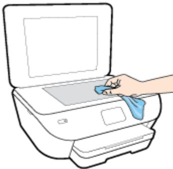
**⚠ CUIDADO:** Use somente produto de limpeza de vidro para limpar o vidro do scanner. Evite produtos de limpeza que contenham materiais abrasivos, acetona, benzina e tetracloreto de carbono, pois todas essas substâncias podem danificar o vidro do scanner. Evite álcool isopropílico, porque ele pode deixar listras no vidro do scanner.
