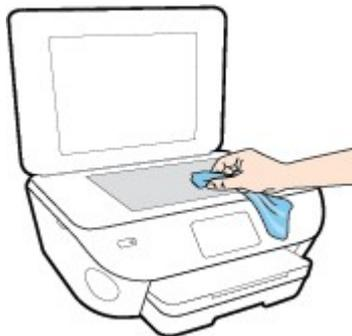
**⚠ ATTENZIONE:** Per pulire il piano di scansione utilizzare esclusivamente un detergente per vetri. Non utilizzare detergenti che contengono sostanze abrasive, acetone, benzene o tetracloruro poiché possono danneggiarlo. Non utilizzare alcool isopropilico poiché potrebbe rigarlo.
