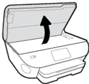
3. Проверьте механизм подачи бумаги внутри принтера.
