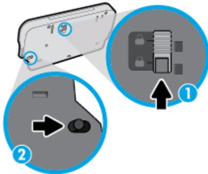
3. Remettez le bac de sortie en place dans l'imprimante en laissant la rallonge dans la position libérée.
