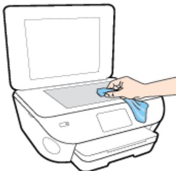
**ATTENTION :** Pour nettoyer la vitre du scanner, utilisez exclusivement du produit de nettoyage des vitres. Évitez les produits nettoyants contenant des abrasifs, de l'acétone, du benzène ou du tétrachlorure de carbone, car ceux-ci risquent d'endommager la vitre du scanner. Évitez l'alcool isopropylique, car il peut laisser des traces sur la vitre du scanner.
