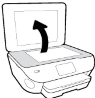
2. Nettoyez la vitre du scanner et la partie inférieure du capot au moyen d'un chiffon doux non pelucheux sur lequel a été vaporisé un produit doux de nettoyage pour vitres.
