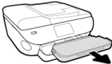
2. Au bas du bac de sortie, placez le verrou du bac sur la position déverrouillée et actionnez le levier de dégagement pour libérer la rallonge du bac.
