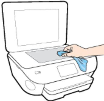
**⚠ 注意：** 只能使用玻璃清洁剂清洁扫描仪玻璃板。避免使用包含研磨剂、丙酮、苯和四氯化碳的清洁剂，所有这些物质都会损坏扫描仪玻璃板。避免使用异丙醇，因为它会在扫描仪玻璃板上留下条纹。
