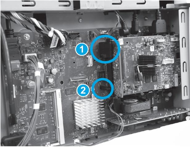
**ID** Pastikan konektor pengunci (gambar 1) terpasang dan penahan kunci (gambar 2) terkait dengan slot dalam pemformat (Anda mungkin perlu menjepit penahan untuk mengaitkannya dengan slot).
