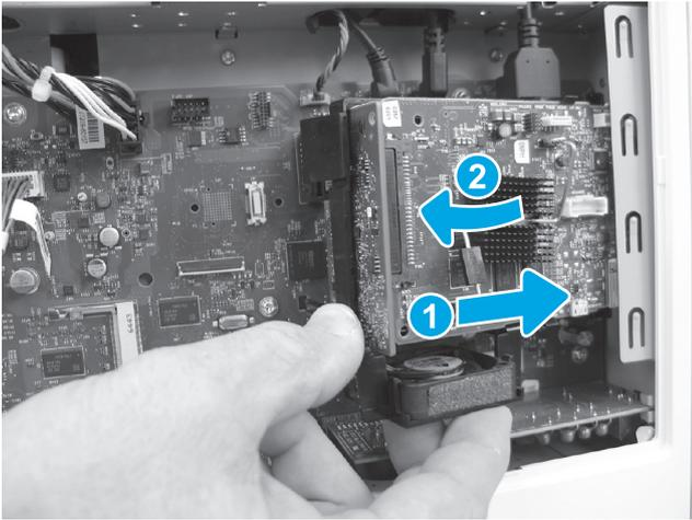
**JA** HDD クレードルの取り付けタブをシートメタルのスロットに挿入し、HDD をフォーマッタ ケージ(1)の方向にスライドさせ、タブを完全にシートメタルに取り付けます。その後、HDD のコネクタの端(2)をフォーマッタの方に回転させます。
