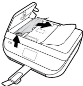
**⚠ 注意：**如果纸张在从滚筒里取出时破损，请检查滚筒和齿轮，看是否有碎纸片留在打印机里。如果没有从打印机中取出所有纸片，将会发生更多的卡纸现象。
