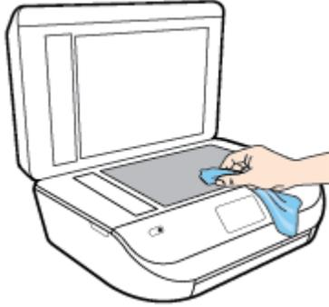
**⚠ 注意：**請務必使用玻璃清潔液清潔掃描器玻璃板。請避免使用含有研磨劑、丙酮、苯和四氯化碳的清潔液，否則會損壞掃描器玻璃板。請避免使用異丙醇，因為會在掃描器玻璃板上留下條痕。
