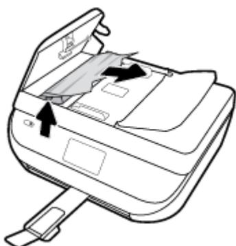
**△ 注意：**如果從滾筒中取出紙張時將紙張撕破，請檢查印表機中的滾筒或滾輪上是否有殘留紙張碎片。
