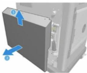
3. Ослабьте винты, крепящие левое окно блока печати к конструкции блока печати. На блоке печати 3D-принтера HP Jet Fusion 4200 имеется шесть винтов.
