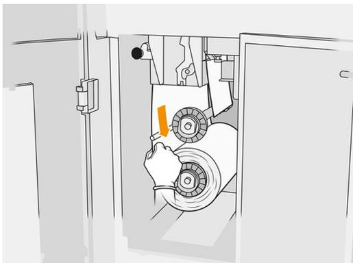
11. Снимите втулку нижнего рулона, нажав на лапку, после этого снимите нижний рулон.
