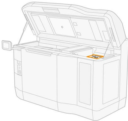
2. Очистите крышки станции технического обслуживания, используя безворсовую ткань, смоченную в промышленном чистящем средстве общего назначения, например Simple Green.
