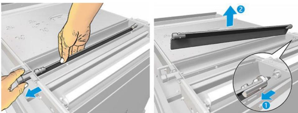
2. Откройте крышку редуктора направляющего устройства. Для этого выкрутите три винта из крышки с помощью звездообразной отвертки 10. Надавите на лопастную муфту внутри лотка для материала, чтобы вывести зубчатые колеса из зацепления (будьте осторожны, так как поначалу это будет тяжело сделать, но как только зубчатое колесо выйдет из зацепления, оно выпадет из корпуса вместе с крышкой).
