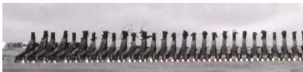
5. Очистите правую сторону гнезда печатающей головки (не сторону с контактами) с помощью мягкой щетки, например зубной щетки.
