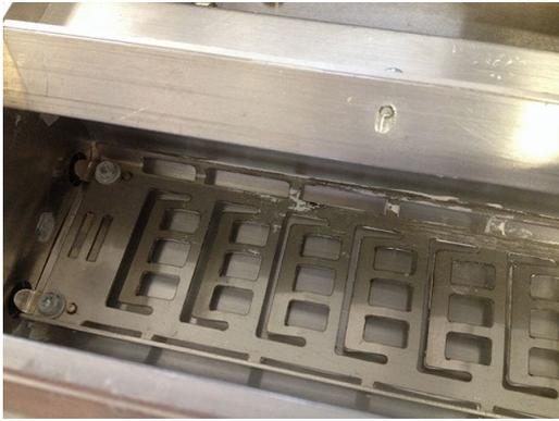
9. Очистите скребок устройства для повторного нанесения покрытия в задней части.
