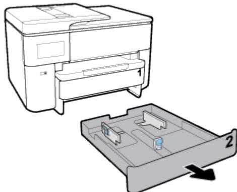
2. 檢查印表機內進紙匣所處之位置の間隙。進入間隙，取出卡紙。
