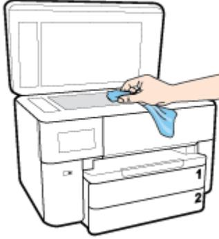
**⚠ 注意：**請務必使用玻璃清潔液清潔掃描器玻璃板。請避免使用含有研磨劑、丙酮、苯和四氯化碳的清潔液，否則會損壞掃描器玻璃板。請避免使用異丙醇，因為會在掃描器玻璃板上留下條痕。
