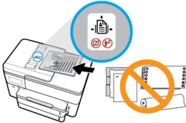
2. 將紙張寬度導板向裡推，直到接觸到紙張的左右邊緣後停止。
