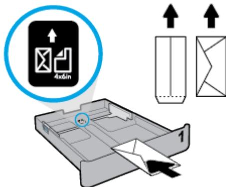
確保整疊信封與紙匣前端相應的紙張大小線對齊。此外，請確定整疊信封未超過紙匣右邊緣的疊放高度標記。
