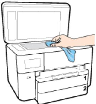
**⚠ 注意：**請務必使用玻璃清潔液清潔掃描器玻璃板。請避免使用含有研磨劑、丙酮、苯和四氯化碳的清潔液，否則會損壞掃描器玻璃板。請避免使用異丙醇，因為會在掃描器玻璃板上留下條痕。
