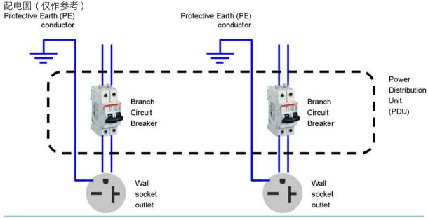
**② 注**:配电装置 (PDU) 的额定参数必须符合打印机的电源要求,并且应符合设备安装所在国家/地区当地司法辖区的电气规范要求。
