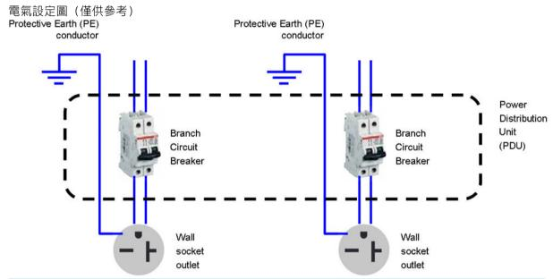
**附註**:配電裝置 (PDU) 等級必須滿足印表機的電力需求,並且應當符合裝置安裝所在國家/地區之當地管轄區電工法規的要求。
