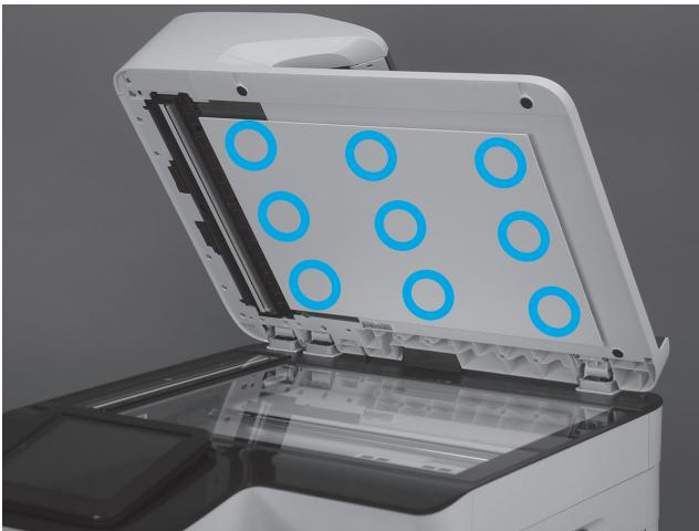
**TH** เปิดตัวป้อนเอกสาร จากนั้นให้กดที่ตัวยึดแผ่นสะท้อนแสงทั้งเก้าจุด เพื่อตรวจสอบว่าเมื่อกดติดกับแผ่นสะท้อนแสงอย่างแน่นหนา
