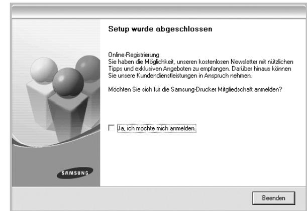
**HINWEIS:** Wenn der Druckertreiber nach dem Abschluss des Setups immer noch nicht funktioniert, installieren Sie den Treiber neu. Weitere Informationen finden Sie unter „Druckersoftware neu installieren“ auf Seite 11.
