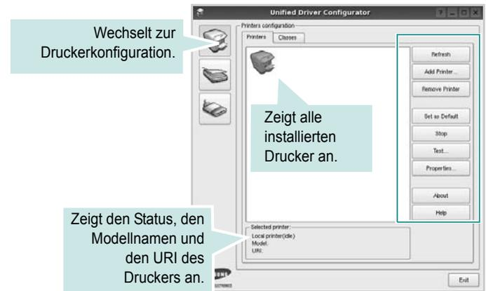
Für die Druckersteuerung können Sie folgende Schaltflächen verwenden:
