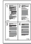
Sie können die Anzahl der Seiten auswählen, die auf ein einzelnes Blatt gedruckt werden sollen. Wenn Sie mehr als eine Seite auf ein Blatt drucken möchten, werden die Seiten verkleinert und in der von Ihnen angegebenen Reihenfolge angeordnet. Sie können bis zu 16 Seiten auf ein Blatt drucken.
