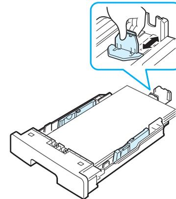
Si utiliza papel de un tamaño inferior al papel de tipo carta, ajuste la guía de longitud frontal hasta que toque ligeramente la pila de papel.
