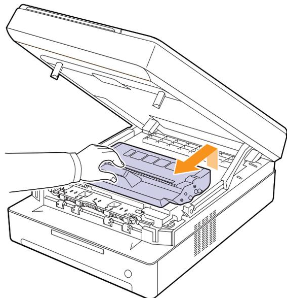
3 Удерживая картридж за его бока, потрясите его из стороны в сторону, чтобы перераспределить тонер внутри картриджа.
