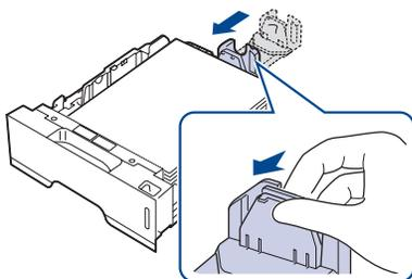
3. 如圖所示握緊紙張寬度導軌，並向紙疊方向滑動，直到輕觸紙疊邊緣。
