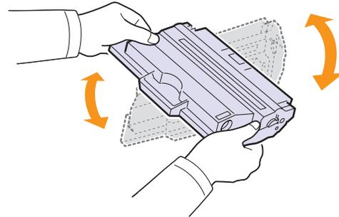
Drehen Sie die Kartusche sorgfältig, um eine maximale Ausbeute sicherzustellen. Bewahren Sie die Versandverpackung und den Kunststoffbeutel auf.
