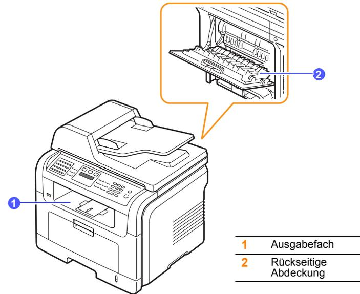
Der Drucker sendet Druckergebnisse standardmäßig an das Ausgabefach. Wenn das Ausgabefach verwendet werden soll, muss die rückseitige Abdeckung geschlossen sein.
