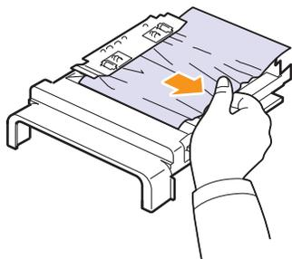
Wenn das Papier nicht zusammen mit der Duplexeinheit herauskommt, müssen Sie das Papier aus dem Boden des Gerätes entfernen.
