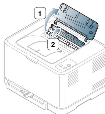
6. 打开内盖板，小心地将卡纸从打印机中拉出。然后，内盖板会自动关闭。
