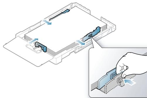
对于比 Letter 尺寸小的纸张，将纸张导轨退回原位，然后调整纸张长度导轨和纸张宽度导轨。
