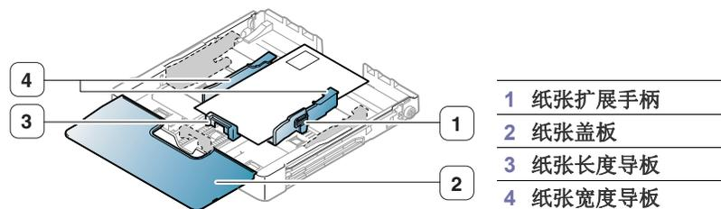
1. 将纸盘从打印机中拉出。打开纸张盖板，如有必要，还可取出纸张。
