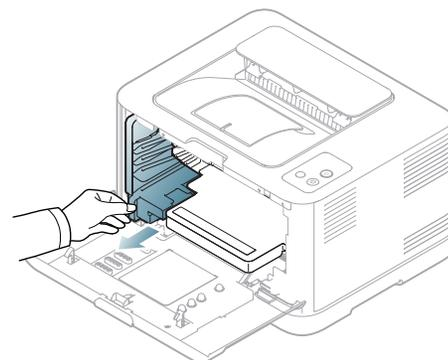
5. 使用成像装置前端的凹槽将其从打印机中拉出。
