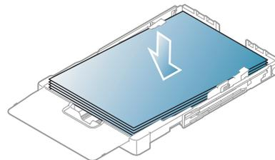
3. 夹紧纸张宽度导板，然后朝纸张宽度方向调节，直到其轻触纸叠末端。不要过于用力，否则纸张会弯曲，而导致卡纸或歪斜。
