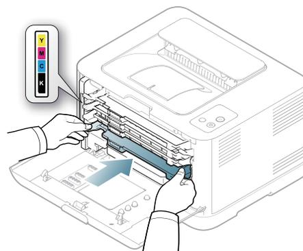
10. 重新将所有墨粉盒舱装入打印机中，然后关闭前盖。
