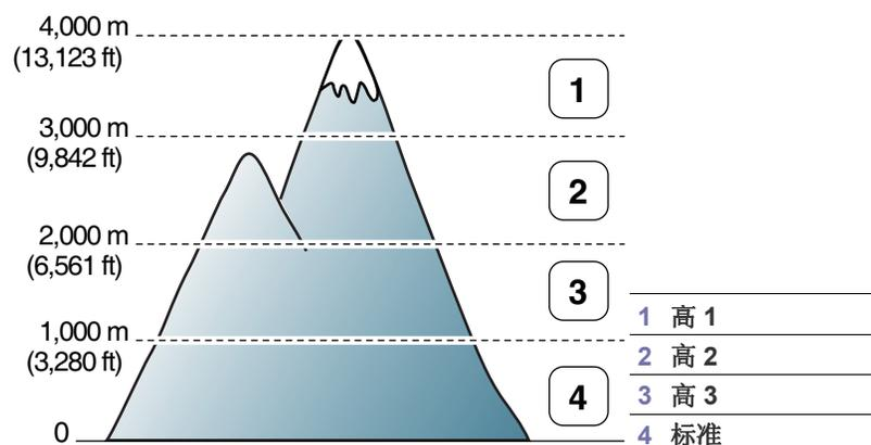
可以在打印机设置工具中调整高度。
