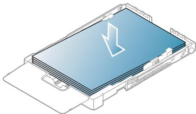
4. 滑动纸张长度导轨，直到它轻轻触及纸叠的末端。捏住纸张宽度导轨，滑动它，使其触及纸叠的边缘但又不致让纸叠打弯。
