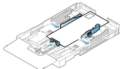
如果需要打印的纸张长度不足 222 毫米，按下纸盘导板锁将其松开，手动推动纸盘。调整纸张长度导板和纸张宽度导板。
