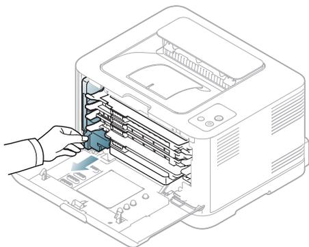
**!** 务必将废粉仓放在平整的台面上，以免墨粉洒落。
