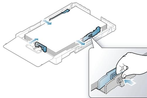
对于比 Letter 尺寸小的纸张，将纸张导板退回原位，然后调整纸张长度导板和纸张宽度导板。
