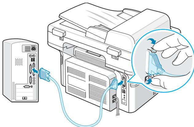
К порту параллельного интерфейса компьютера
