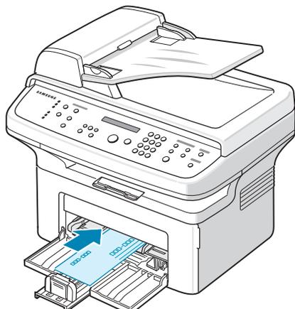
将打印介质推入手动纸盘并固定。
