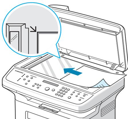
**注意：** 确保 ADF（自动进纸器）中没有任何文档。如果在 ADF 中检测到文档，它的优先级将高于文档扫描玻璃板上的文档。
