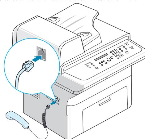
2 如图所示握住话筒机座，将其连接到机器上。
