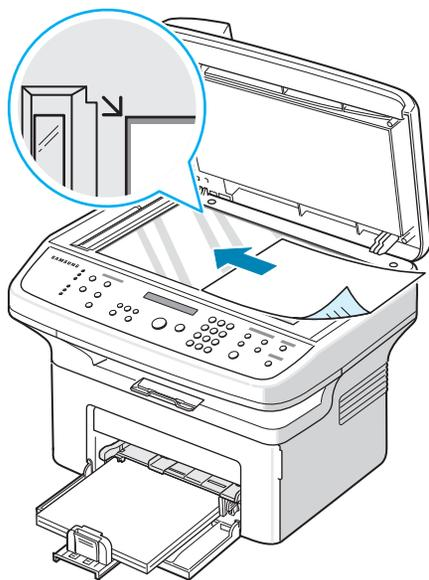
**注意：** 确保在 ADF（自动进纸器）中没有其它文档。如果在 ADF 中检测到文档，它的优先级将高于文档扫描玻璃板上的文档。
