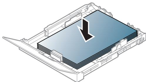
Si el papel tiene un tamaño inferior a Letter, pulse y desbloquee la guía de la bandeja, empuje la bandeja de forma manual. A continuación, ajuste la guía de longitud del papel y la guía de ancho del papel.
