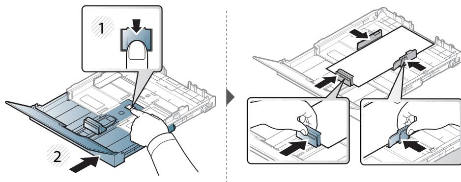
Si el papel tiene un tamaño superior al A4 (como Legal), pulse y desbloquee la guía de la bandeja, saque la bandeja de forma manual. A continuación, ajuste la guía de longitud del papel y la guía de ancho del papel.
