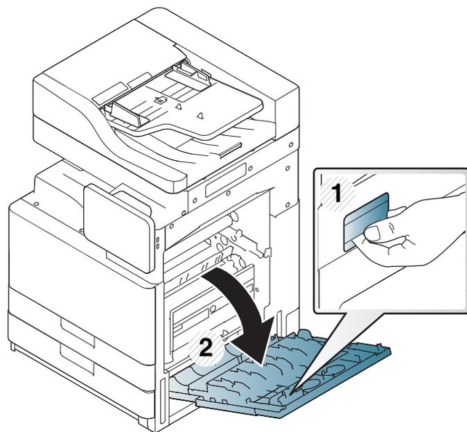
2 Abra la cubierta del fusor. Para retirar el papel atascado, tire de él con cuidado hacia afuera.
