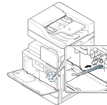
**6** Inserte el contenedor de tóner residual hasta que quede bien colocado.
