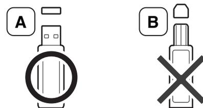
Utilice únicamente un dispositivo de memoria USB con conector de metal.
