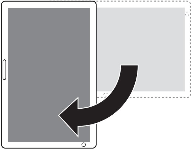
Puede girar el panel de control 90 grados. Cuando gira el panel de control, la orientación de la pantalla se ajusta automáticamente para adaptarse al funcionamiento del panel de control.
