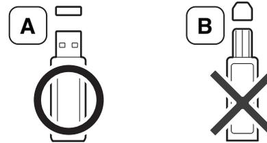
Utilice únicamente un dispositivo de memoria USB con conector de metal.
