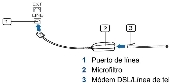
Antes de enviar o recibir un fax, debe conectar el cable de línea suministrado a la toma de la pared. Consulte la “Guía rápida de instalación”. El método de conexión de la línea telefónica varía en función del país.
