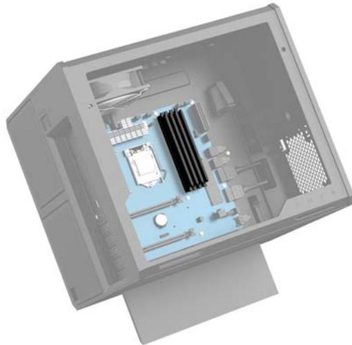
Je nachdem, wie die DIMMs installiert sind, arbeitet das System automatisch im Einkanalmodus, im Zweikanalmodus oder im Flex-Modus.
